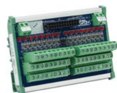
ZL-LTB16-24-1 sensor input module
