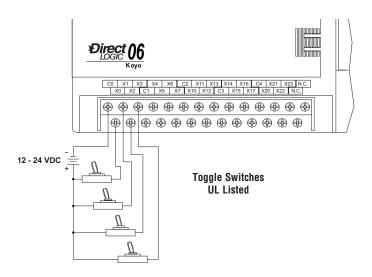
D0-06DA, D0-06DD1, D0-06DD2, D0-06DR, D0-DD1-D, and D0-06DR1-D DC Input
